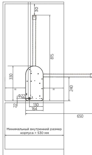
Определите расстояние в корпусе под левую боковину пантографа (1), чтобы сделать вырез для проводки (скрытой или наружной) и отверстия, через которое будет проходить провод. Протяните провод блока питания (8) через вырез или отверстие.
